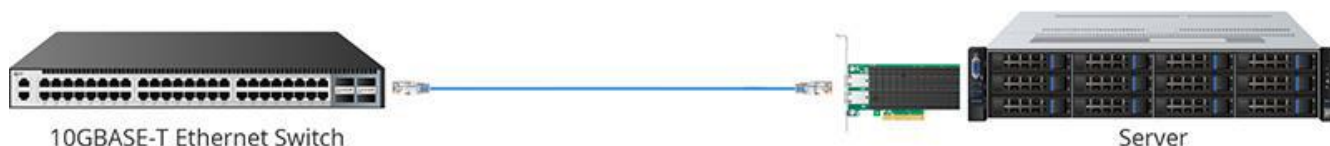
Imagen 2: El cable Cat6 se conecta a la tarjeta de red 10GBASE-T para realizar la transmisión
